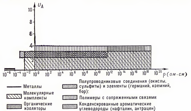
Удельное электросопротивление \rho и энергия активации U_A электропроводности органических и неорганических полупроводников.
